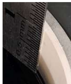
б) Зовнішній ізолятор після 120-ти годинних випробувань
