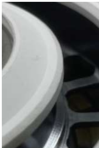
а) Внутрішній ізолятор до випробувань
