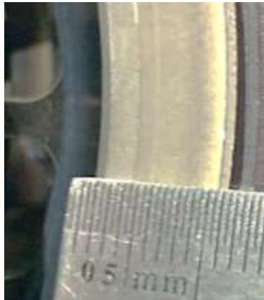
б) Зовнішній ізолятор після 8-ми годинних випробувань
