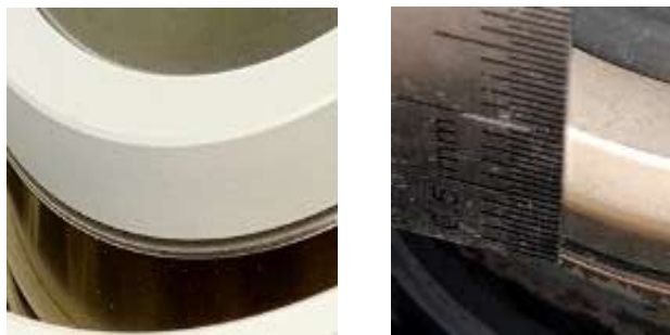
а) Внутрішній ізолятор до випробувань
