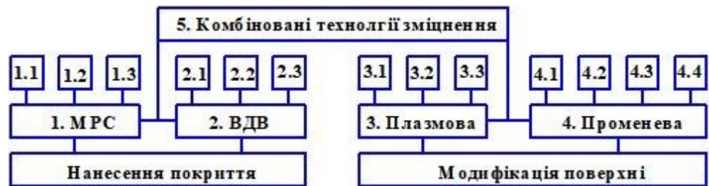
Рис. 1 – Іонно-плазмові і іонно-променеві технології і технологічні пристрої для зміцнення робочих поверхонь пар тертя
