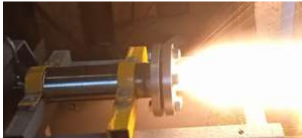
Рис. 6 – Дослідження горіння палива в малорозмірному модельному двигуні
