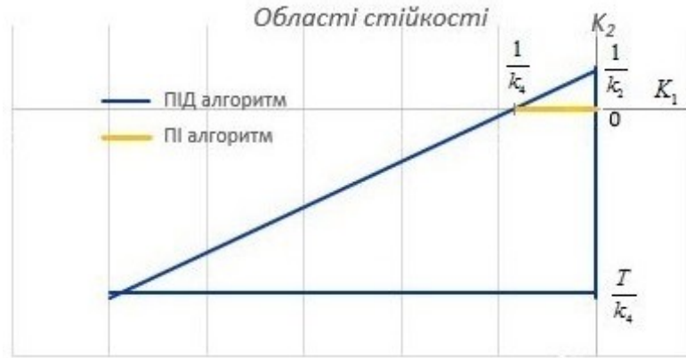
Рис. 1 – Області стійкості алгоритмів формування зворотних зв'язків
